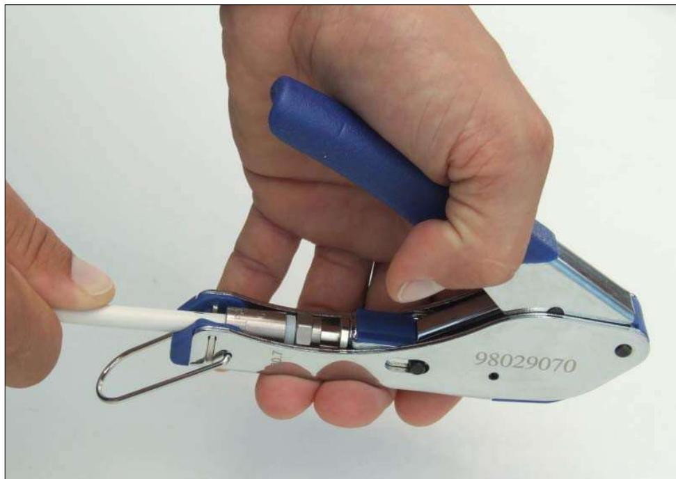
1. Stecken Sie das Kabel mit dem montierten Stecker wie beschrieben ein.
